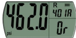
11. Si aucune pression n'est détectée dans le circuit, le manomètre affichera la pression 0.0 et la valeur de la température correspondante de la courbe température pression du réfrigérant.
