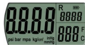
7. Premere il pulsante "ON/OFF", tutti i caratteri si illumineranno per 2 secondi. (Lo stato della batteria e' sempre visualizzato).
