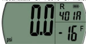
11. Se non viene rilevata pressione sulla linea, il manometro visualizzerà la pressione con "0.0" corrispondente al valore della temperatura e pressione refrigerante /tabella temperatura.
