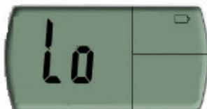
Bei einer Kapazität von 25% bis 50% wird folgendes auf dem Display angezeigt:
