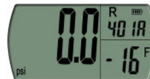
5. Se debe volver a apagar el manómetro antes de aplicarle presión. Mantenga pulsado on/off durante dos segundos para que se apague.
