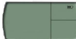
Cuando la carga de las pilas esta entre 50% y 75%, el display muestra:
