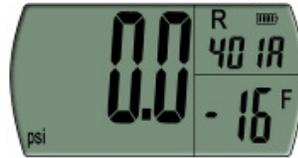
5. Le manomètre doit être une nouvelle fois éteint avant l'application de la pression. Appuyer sur le bouton ON/OFF pendant 2 secondes, le manomètre sera en position OFF
