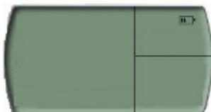
Bei einer Kapazität von 10% bis 25% wird folgendes auf dem Display angezeigt:
