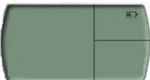
Bei einer Kapazität von mehr als 75% wird folgendes auf dem Display angezeigt:
