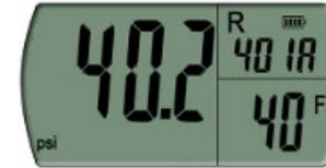
12. Si une pression est détectée dans le circuit, l'affichage montrera la température correspondant au réfrigérant choisi à cette pression.
