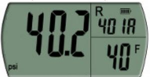
12. Si se detecta presión e la línea la pantalla mostrará la temperatura correspondiente para el refrigerante seleccionado a esa.
