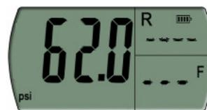
9. Se c' e' bisogno di selezionare il tipo di refrigerante, premere il pulsante "R" fino a visualizzare il tipo di refrigerante desiderato. Il manometro riconoscerà il numero del refrigerante scelto lampeggiando per 3 secondi dopo che questo e' stato selezionato.
