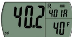
12. Se nella linea viene rilevata la pressione, lo schermo LCD visualizzerà la temperatura corrispondente alla pressione del refrigerante selezionato.
