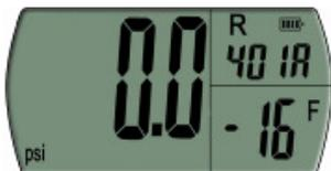
11. Si no se detecta presión en la línea, el manómetro mostrará la presión como 0.0 y el valor correspondiente de temperatura para el refrigerante correspondiente según tablas de presión temperatura.
