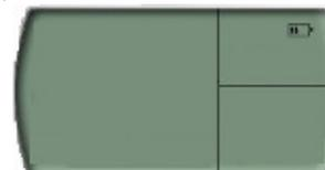
Cuando la carga de las pilas esta entre 10% y 25%, el display muestra:
